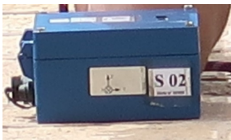
Figura 50 – Sismógrafo Geosig - modelo GSR-18 do laboratório LESE.
