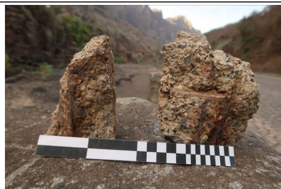
Figura 71 – Amostra de betão recolhida na ribeira e que se pressupõe ser do Montante M5.
