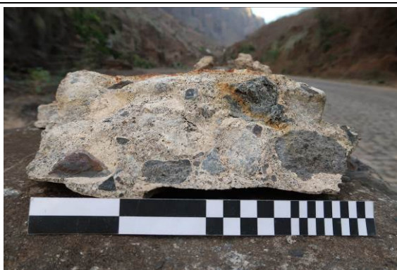
Figura 70 – Amostra de betão recolhida na ribeira e que se pressupõe ser do Arco A1.
