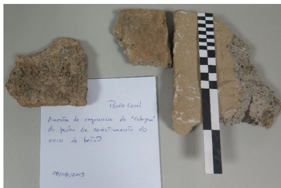
Figura 60 – Amostra de argamassas recolhidas no leito da ribeira.
