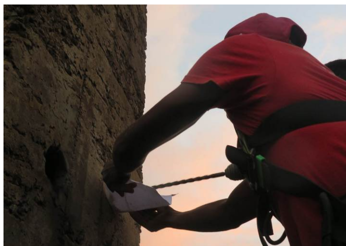
Figura 45 – Recolha de amostra para o teor de cloretos.
