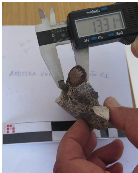
Figura 43 – Medição do varão na carote C1.
