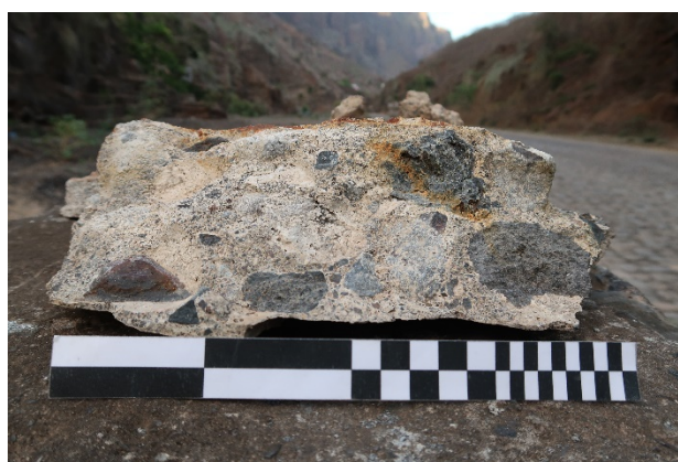
Figura 64 – Amostra de betão do recobrimento do arco A1.
