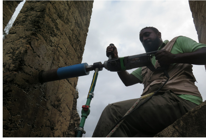
F14: Extração da carote C1 em M6
