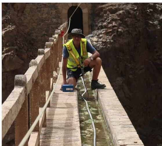
Figura 52 – Posicionamento do sismógrafo num dos pontos de registo.
