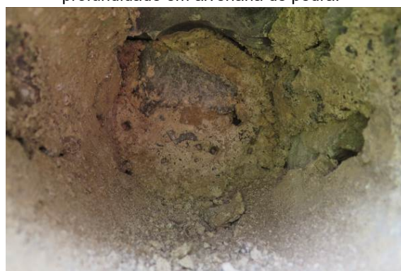
Figura 56 – Sondagem S2 com 30cm de profundidade em alvenaria de pedra.
